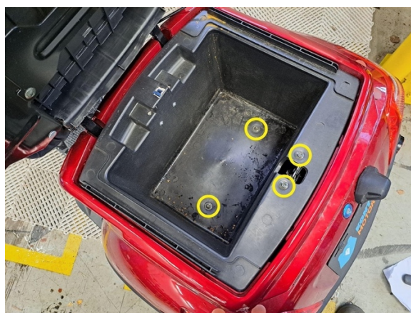
Käännä päävirtakytkin off- asentoon. Irrota säilytyskotilon kiinnityspultit. (hylsy 8 mm).
