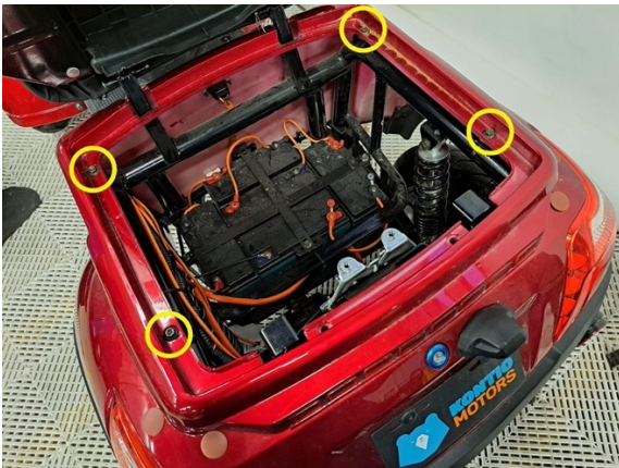
Irrota takakatteen neljä kiinnityspulttia. (hylsy 8 mm).
