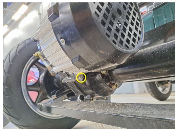
Irrota moottorin alapuolella olevat moottorin kiinnityspultit. (kuusiokoloavain 5 mm).
